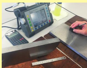
▲溶接部の超音波探傷試験
