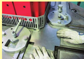
▲機械による切断
