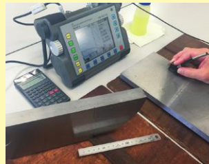
▲溶接部の超音波探傷試験
