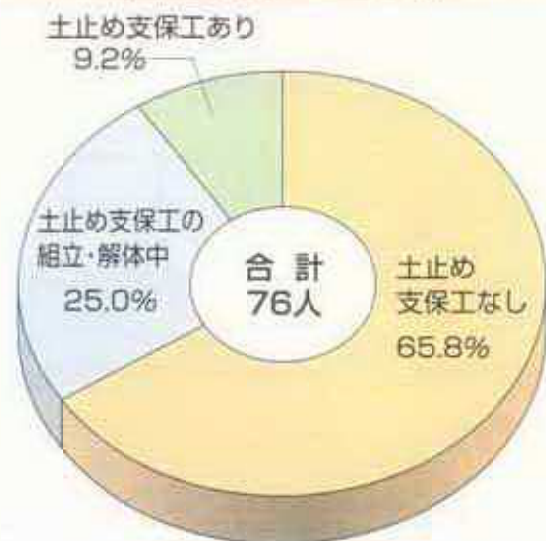
土砂崩壊による死亡災害発生状況 (土止め支保工の状態別)
