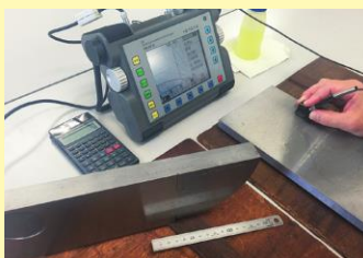
▲溶接部の超音波探傷試験
