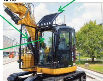
運転室周りの飛来物防護設備の例
