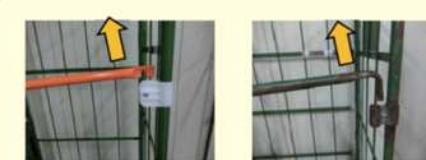
サイドバーを解除して跳ね上げた様子 ※高く上がるとその反動で勢いよく落ちてきて危険！
