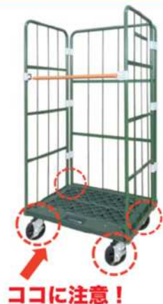
4 輪巡回（自在）タイプを傾いた路面で直進させようとしている様子 ※カスター旋回の影響で逸走してしまい危険！
