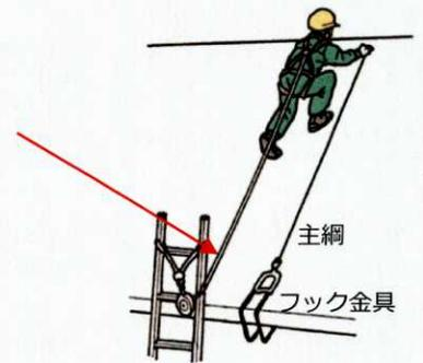
※はしごの踏み機は墜落阻止するための強度が不十分な場合があるので、落下時の荷重が踏み機ではなく、支柱に伝わるようにする。
