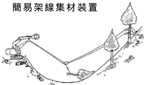
原木等の一部が地面に接した状態で運搬する設備
