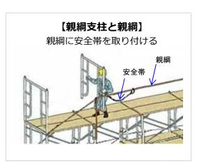
▶墜落する危険を低減させるため、「手すり先行工法」を積極的に採用してください。 足場の一方の側面のみであっても、手すりを設ける等労働者が墜落する危険を低減させるため の措置を優先的に講ずるよう指導すること。(平成27年3月31日付け基発0331第9号)
