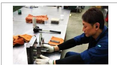
金型課では、射出成形機に乗せて製品を作るための金型のメンテナンス・部品製作をします。□□□
