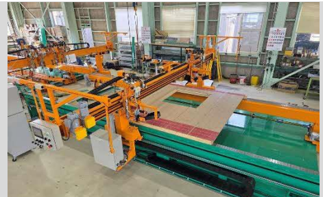
住宅壁パネルの自動釘打ち装置
