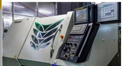
(超高精度高速微細加工機)
