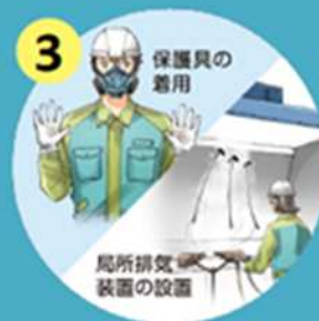
保護具の着用 局所排気装置の設置
