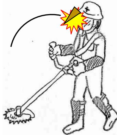
刈払機にて除伐作業中、刈払った木片が飛来し顔に直撃。目を負傷した。被災時に防護眼鏡を外していた。
