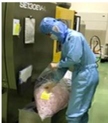
製造課では、射出成形機にて成形された製品を、時間毎に外観の確認をし、袋詰・箱詰します。
