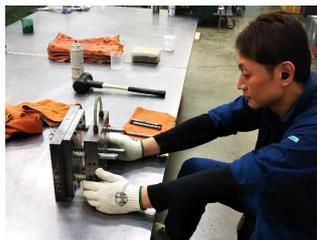
金型課では、射出成形機に乗せて製品を作るための金型のメンテナンス・部品製作をします。
