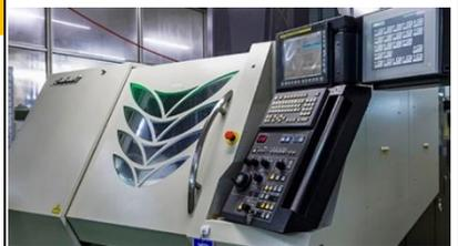
(超高精度高速微細加工機)
