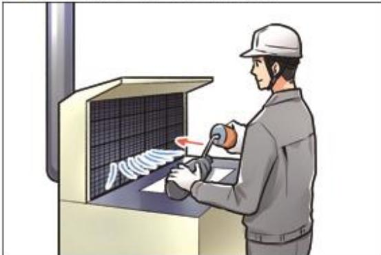
請負人だけが作業を行うときも、事業者が設置した局所排気装置等の設備を稼働させる（または請負人に設備の使用を許可する）等の配慮を行うこと。（有機溶剤中毒予防規則第18条第3項等）
