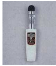
WBGT指数計(例) (JIS規格に適合したもの)
