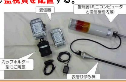
(例)土砂崩壊簡易危険検出システム
