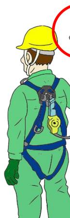
安全ブロックスライド・グリップ等のフックに墜落制止用器具のフックを連結して使用する
