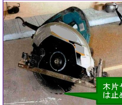
携帯用丸ノコ盤の接触予防装置を固定して使用している事例 (写真は改善後の状況)
