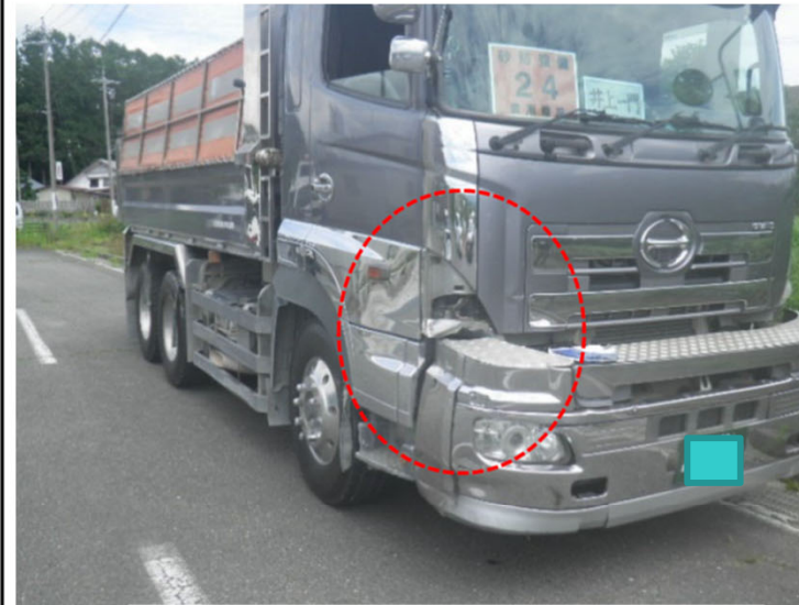
10 t ダンプトラック損傷箇所
