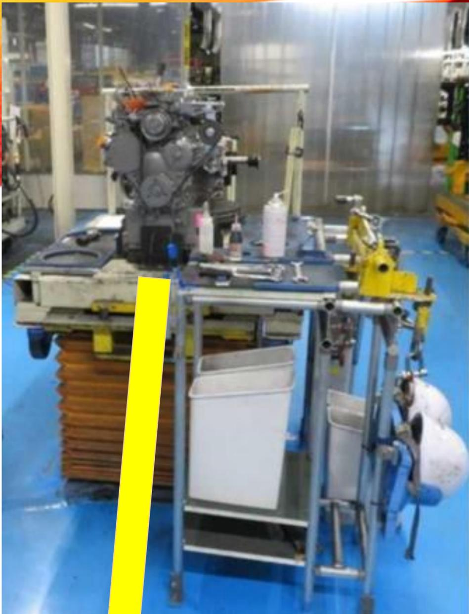
クレーン作業を廃止し、リフターで運搬と作業位置の調整を行い、トルクレンチ締め付け記録を自動化することで、重量物落下リスク低減・作業性・品質の向上を実現(安全と作業性と品質を同時に対策)
