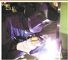
TIG溶接 (ステンレス, アルミニウム, チタンなどの溶接ができます。)
