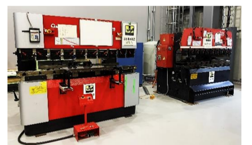
プレスブレーキ (板材の曲げ加工ができます。)
