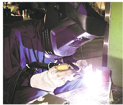
TIG溶接 (ステンレス、アルミニウム、チタンなどの溶接ができます。)
