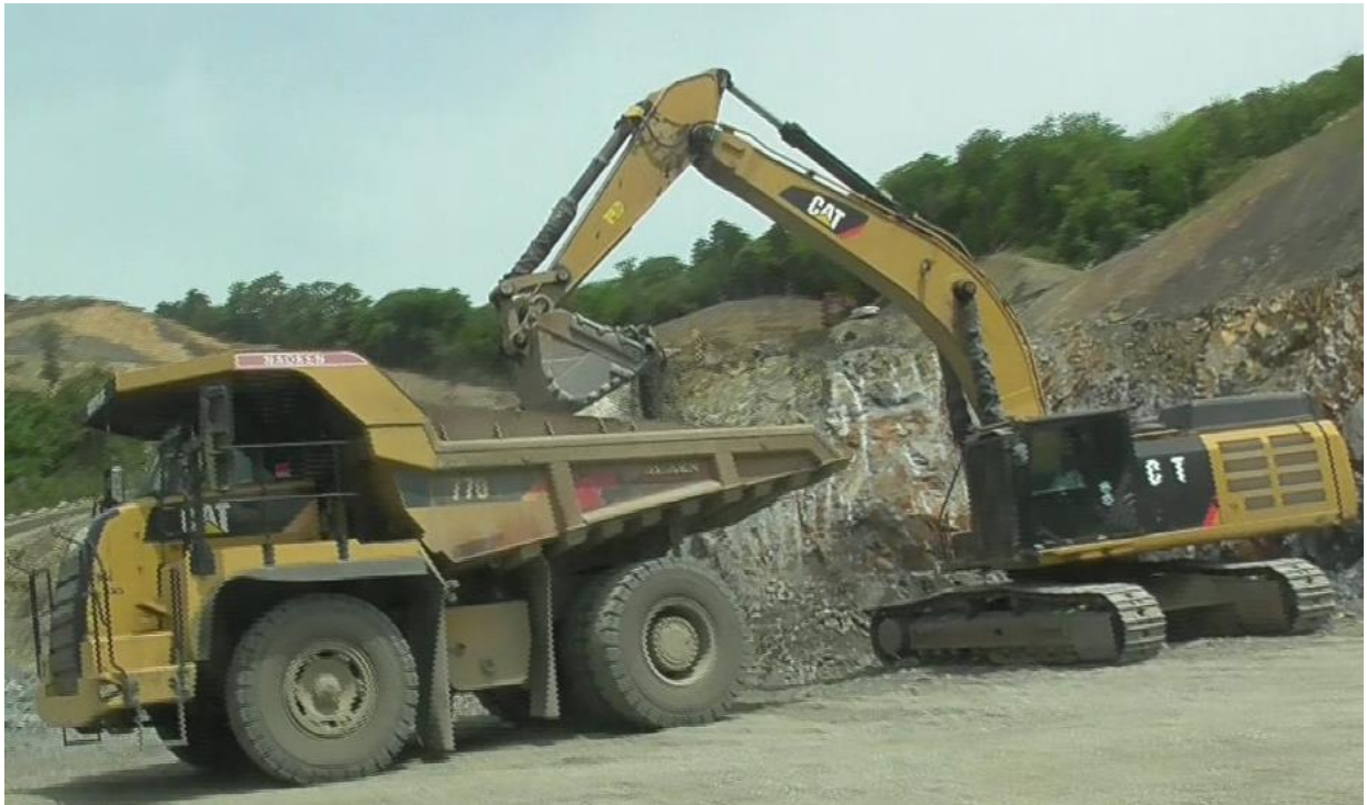
採取した砕石をトラグショベルからダンプカーに積み込んでいる場面
