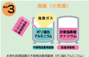
水浄化処埋装置の不純物沈殿用楽剤(ボリ塩化アルミニウム) タンクと殺菌用薬剤(次亜塩素酸ナトリウム)タンクが並んで 設置されていたため、誤って不純物沈殿用薬剤タンクに殺菌 用薬剤を投入してしまい、塩素ガスが発生した。
