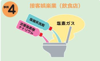
トイレ清掃中に塩酸系洗剤を使用していたところ、途中で洗剤がなくなっため、厨房にあった次亜塩素酸ナトリウムを追加してしまい、塩素ガスが発生した。
