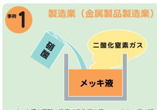
メッキ槽を硝酸で洗浄する作業を行っていたところ、誤って メッキ液が入った槽に硝酸を投入してしまい、メッキ液中の 還元剤と硝酸が反応し二酸化窒素ガスが発生した。
