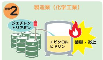
同色のドラム缶に入った液体が同一の薬品だと誤認し、エピクロルヒドリンの入ったタンクにジエチレントリアミンを投入してしまい、内部で反応が起こり圧力が上昇してタンクが破裂、炎上した。
