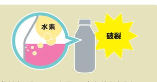
飲料水の入っていたアルミ缶に洗剤を入れていたところ、アルミ缶と洗剤が化学反応を起こして水素が発生し、破裂した。
