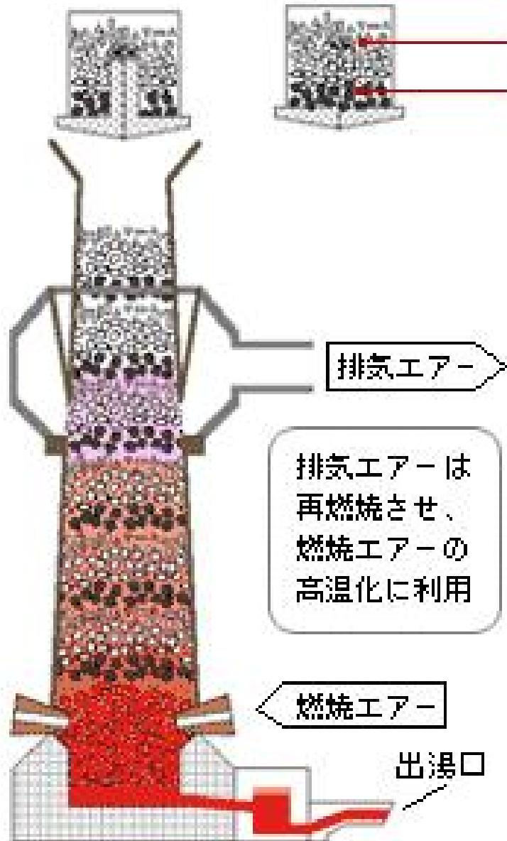
材料 (銑鉄・鋼屑・戻し材)
