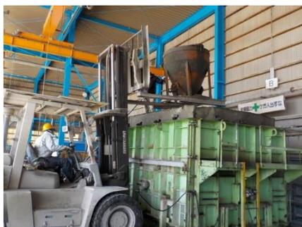
▲フォークリフトを使用して、コンクリートを型枠に流し入れる様子
