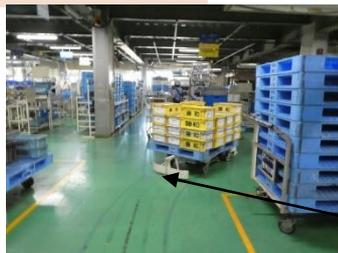
▲自動搬送ロボット（AGV）が磁気テープに沿って各フロアを歩き来してくれます。
