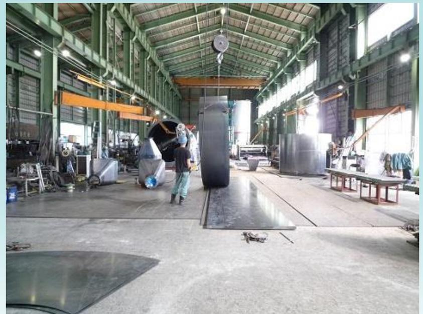
鉄板を筒状にしたものを積み上げ、継ぎ目を溶接していきます。
