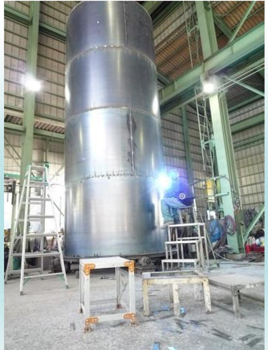
タンク内部のセメントが固まらないようにするためのスクリューを製作しています。男性が多い職場ですが、女性も活躍しています。
