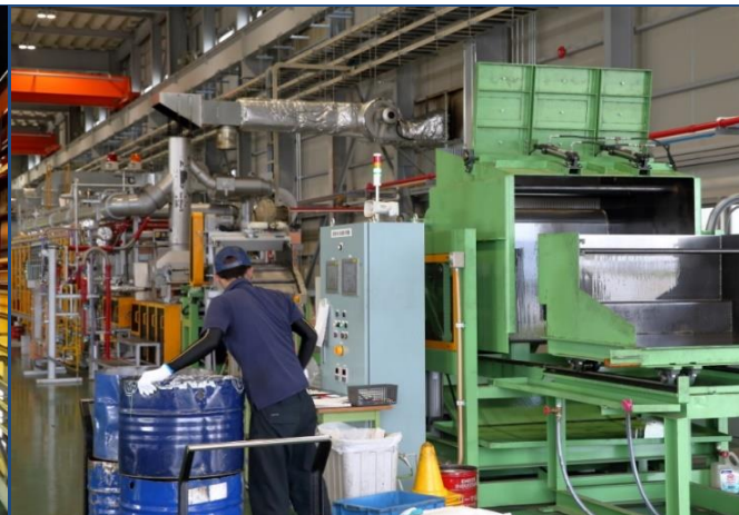
金属製品を熱処理炉に投入
